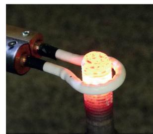
› Erwärmen eines Gewindebolzens mit der wassergekühlten Spule
