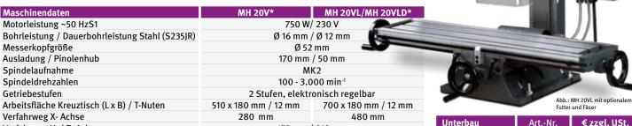
Verfahrweg Y- / Z- Achse 175 mm / 210 mm Abmessungen (L x B x H) ca. 750 x 650 x 820 mm 770 x 714 x 917 mm Nettogewicht ca. 94 kg 99 kg
