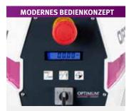
> Gut ablesbares, digitales Display für die Anzeige von Drehzahl, Tiefenanzeige und Nullpunkt
