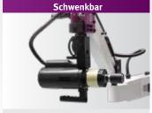
> Schwenkbare Motoreinheit zum Gewindeschneiden in jedem gewünschtem Winkel zwischen 0° und 90°
