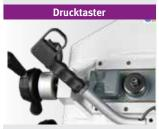
> Manueller Sägebandlauf - am Handhebel schaltet den Lauf des Sägebandes ein und aus
