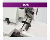
> Zum konischen Außen- oder Innenschleifen kann der Tisch um +3° / -9° gedreht werden.
