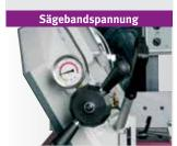
> Einfache und richtige Einstellung der Sägebandspannung mittels Manometer
