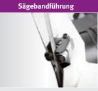
Kugelgelagerte Sägebandführung für hervorragenden Bandlauf und somit für optimalen Schnitt
