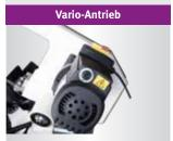
Stufenlos einstellbare Sägeband-Geschwindigkeit von 30 bis 80 m/min
